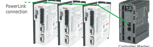
Controllo degli azionamenti tramite comandi da Controllore Master.
