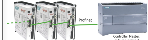
Controllo degli azionamenti tramite comandi da Controllore Master.
