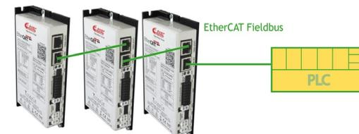
Controllo degli azionamenti tramite comandi da Controllore Master
