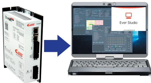
Seriale di servizio SCI, per la configurazione ed il debug in real time, senza interrompere il lavoro dell'azionamento e del PLC.
