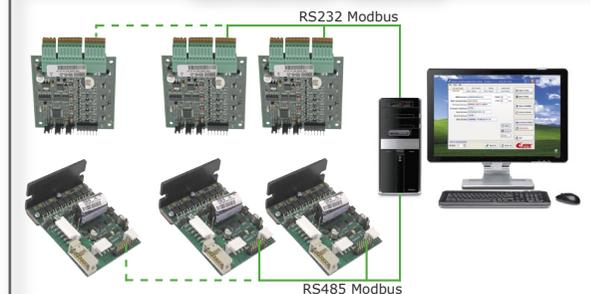
Tramite l'interfaccia seriale è possibile controllare la rotazione in posizione e velocità del motore ed avere accesso alle risorse hardware di cui gli azionamenti "open frame" sono dotati. Ad esempio è possibile controllare il valore degli I/O digitali e analogici, oppure monitorare lo stato di funzionamento dell'azionamento.
